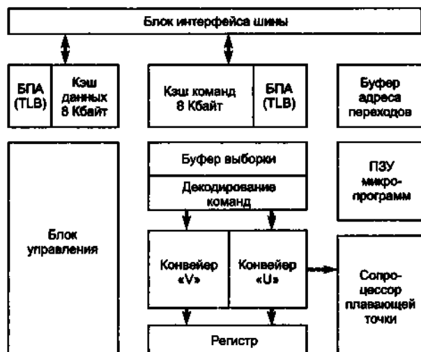
Рис. 3.17. Основные компоненты процессора Pentium
